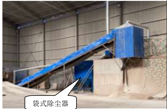
破碎工序收集及袋式除尘器
